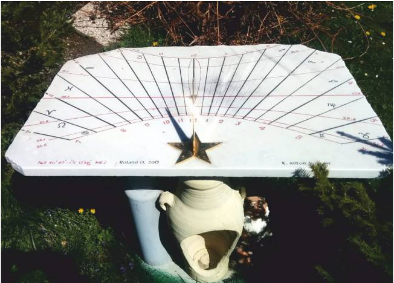
Anton Volgger aus Südtirol hat diese Uhr in Lienz, Linker Drauweg in eine Platte aus Laaser Marmor gemeißelt. Sie zeigt die Schleife der Zeitgleichung für die Mittagsstunde, sie gilt aber für alle Stunden.
