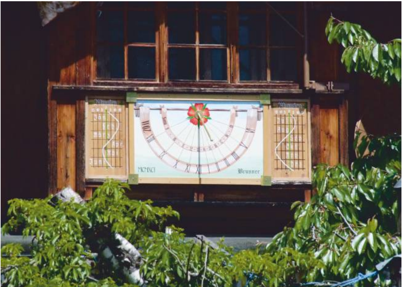
In einer Seitengasse der Alleestraße hat der Hausbesitzer eine Sonnenuhr am Balkon angebracht. Sie ist auf eine Tafel gemalt. Die beiden seitlichen Holzplatten zeigen die Zeitgleichungs-Korrekturwerte für je ein Halbjahr.
